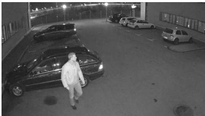
Когда освещенность падает ниже определенного уровня, камеры могут автоматически переключаться в ночной режим.
